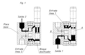
mientos del pistón ilustrados en la fig. 1 muestra el funcionamiento del dosificador alternando la alimentación del lubricante cuando entra por la línea 1 o cuando entra por la línea 2.
